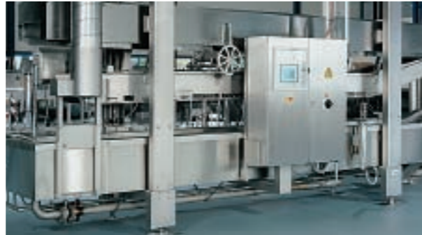
В обжаривателе GoldFryer имеется свободный доступ ко всем частям машины для удобства технического обслуживания.
