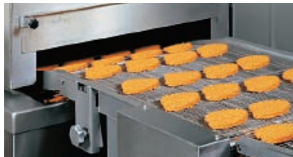
В обжаривателе GoldFryer имеется свободный доступ ко всем частям машины для удобства технического обслуживания.
