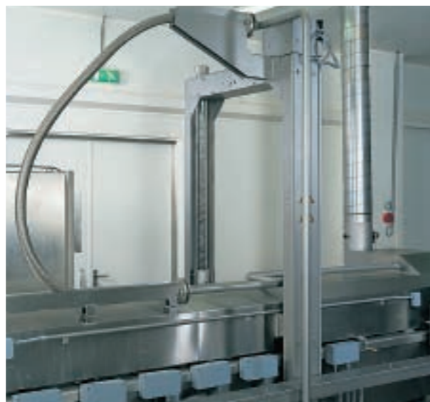
Подъемник обеспечивает удобный доступ к внутренним частям GoldFryer.
