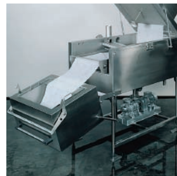
Во время работы печи для жарки система фильтрации масла OilFilter с байпасом компании Townsend Further Processing удаляет взвешенные в масле частички загрязнений.
